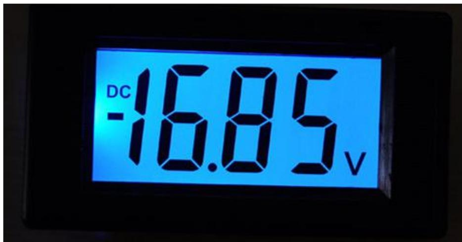
图 3-2 数字电压表示意图
