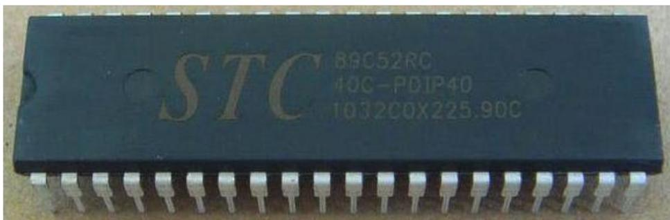
图 3-7 PDIP40 的封装示意图
