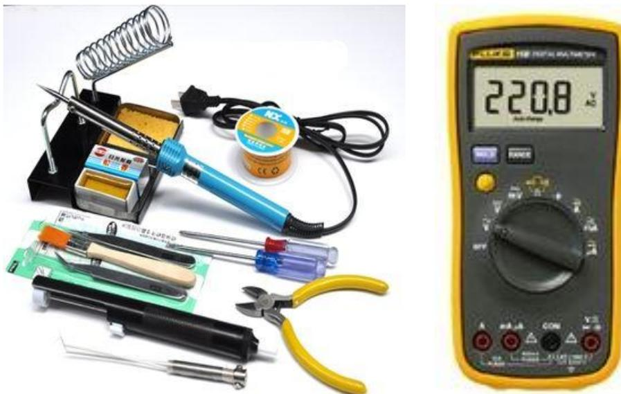
图 3-24 焊接和测试所需的基本工具
